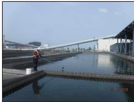
รูปที่ 3-6 การเก็บตัวอย่างน้ำเสีย และน้ำที่ผ่านการบำบัดจากระบบบำบัดน้ำเสีย จากกิจกรรมท่าเรือ และลานกองเก็บถ่านหิน
